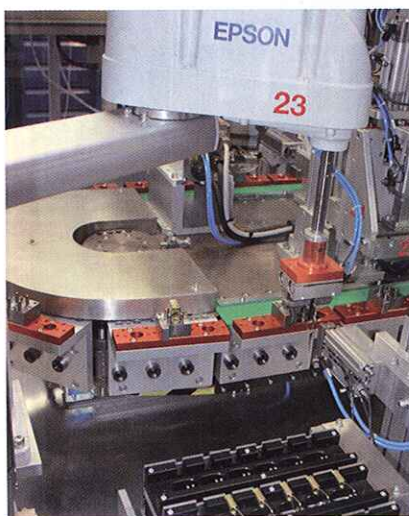
I robot Scara forniti da Sinta fanno parte della serie G modello G3-351S e sono comandati da unità di controllo dedicate modello RC180
