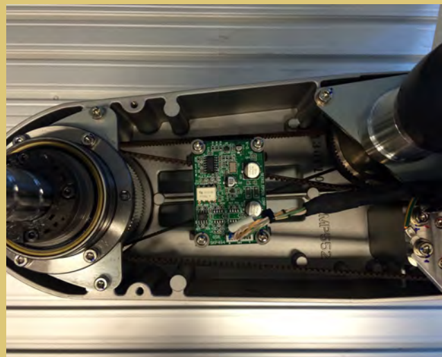
Il sensore QMEMS integrato.
