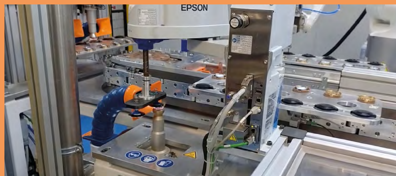
Uno SCARA T3 Epson si occupa dell'handling nella fase di trattamento della lente.
